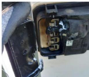
Diode difettoso che compromette il modulo fotovoltaico.
