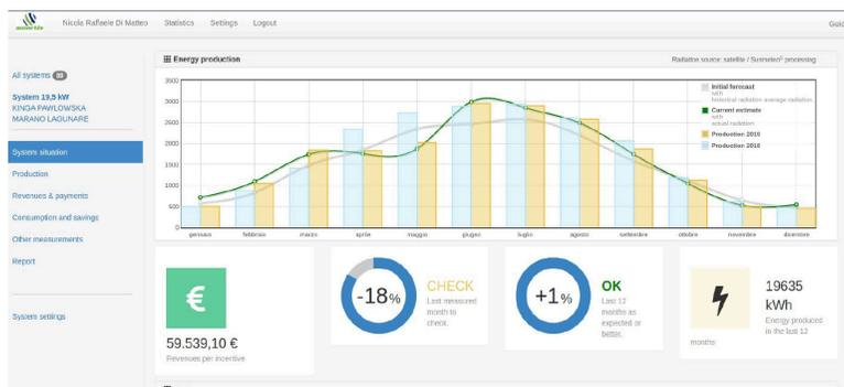
Questa è una delle analisi che si può ottenere: le barre gialle rappresentano la produzione, la linea verde la nostra stima fatta a norma UNI 8477 con radiazione solare puntuale in quel preciso punto in quel preciso periodo (mese giorno ora) ricavata dal satellite meteorologico Meteosat.
